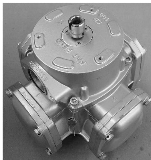
Рисунок Г.3 Пломбировка измерителя объёма
